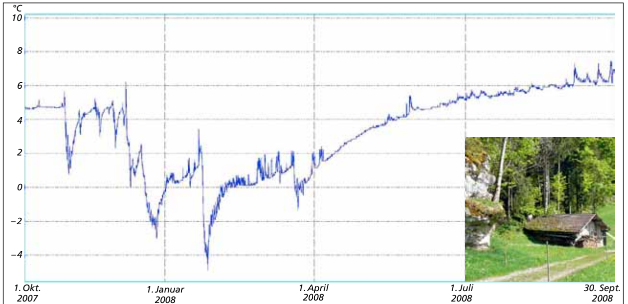
Ein typischer Temperatur-Jahresverlauf im Kühlhäuschen Oberenglerls (kleines Bild) oberhalb von Grafenort. Im Winter werden die Bergsturz-Hohlräume ausgekühlt. Die so abgekühlte Luft strömt in der wärmeren Jahreszeit aus den Blasspalten. Bis zum Herbst steigt die Temperatur langsam, aber stetig an. Danach beginnt der Kreislauf von Neuem. Grafik: Elpro-Auswertsoftware.
